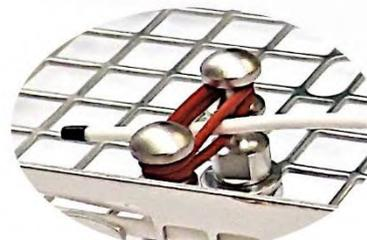
Abbildung III: Sondenkopf im Siebkorb fixiert im Siebkorb fixiert
