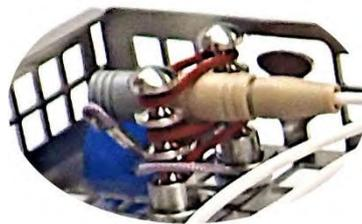
Abbildung II: Stecker mit Schutzkappe (REF 6542) im Siebkorb fixiert
